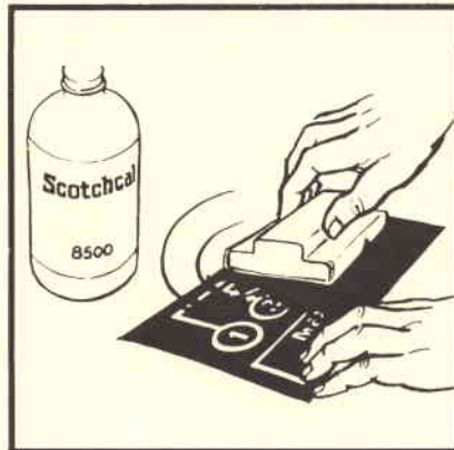
Fig. 16 - Con un tampone si sviluppa lo Scotchcal.
