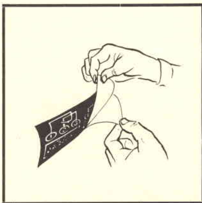
Fig. 18 - Separazione della carta protettiva dell'adesivo.
