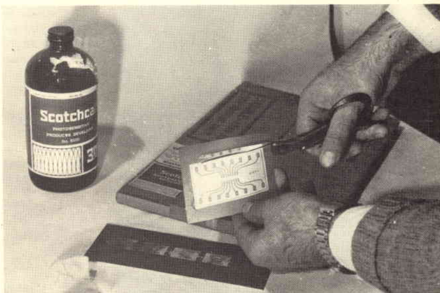
Fig. 24 - Nonostante l'elevata consistenza e solidità dello Scotchcal è possibile rifinire il pannello o l'etichetta con una normale forbice o una taglierina per carta.
